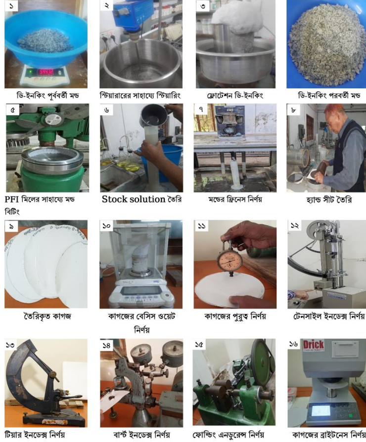
চিত্রঃ মন্ডের ডি-ইনকিং ট্রিটমেন্ট (১-৪), ট্রিটমেন্টকৃত মন্ড হতে কাগজ তৈরি (৫-৯) এবং কাগজের ভৌত ও অপটিক্যালধর্ম নির্ণয় (১০-১৬)।
